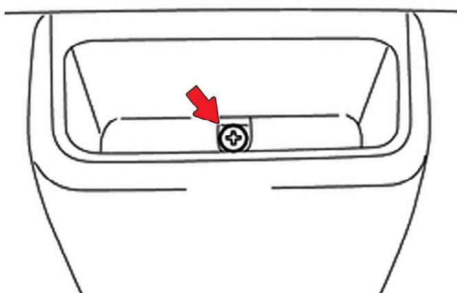
**5** Отверните **болт** и снимите **крышку** троса аварийного открывания багажника, снимите панель облицовки двери багажника в сборе.
