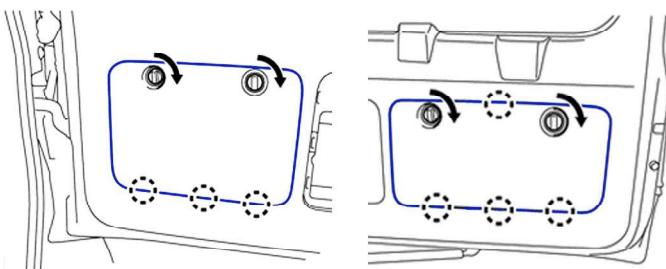
**4** Снимите заглушку, выверните **винт** из ручки закрывания двери багажного отделения.
