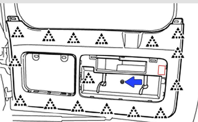
**6** Отклейте верхнюю часть **полиэтилена**, закрывающего технологическую нишу.
