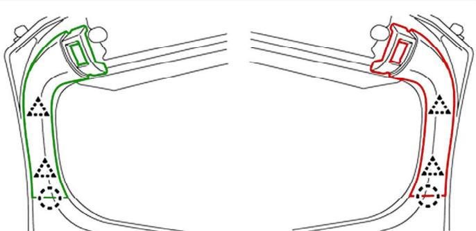
**3** Снимите **облицовочные накладки** двери багажного отделения.
